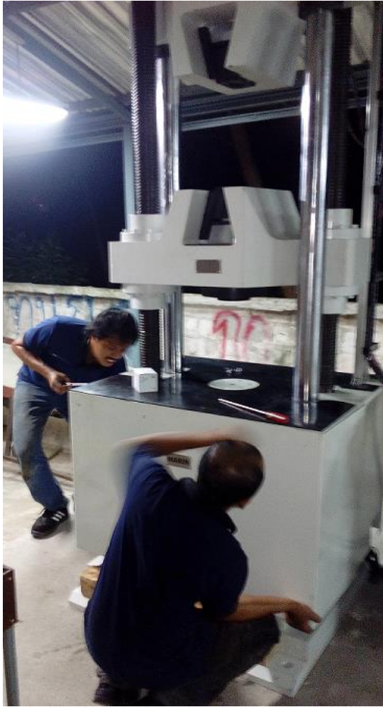
ภาพแสดงการติดตั้ง เครื่องทดสอบ NRI-TH-501-600 : 600kN
