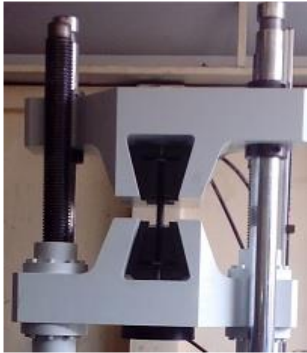
ภาพแสดงการติดตั้ง เครื่องทดสอบ NRI-TH-501-600 : 600kN
